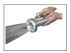
扇形に拡がるチップ(扇角度40°)を 特徴 4個ガン先に取り付けて、ロックウールを セメントスラリーで囲むようにして 吹付けを行うガンです。
