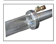
扇形に拡がるチップ(扇角度40°)を 特徴 6個ガン先に取り付けて、ロックウールを セメントスラリーで囲むようにして 吹付けを行うガンです。 4穴ガンより更にロックウール材を囲めるのが 特徴です
